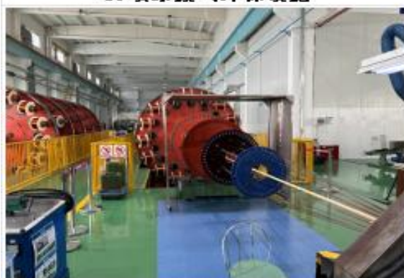
7. 换位导线生产工段
