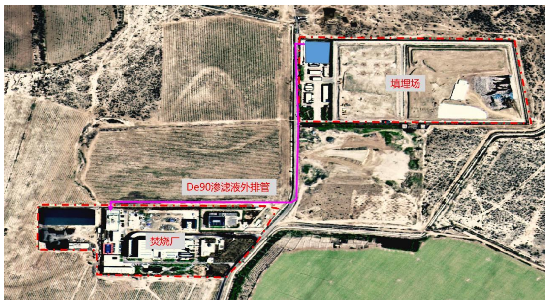
图 8.2-2 渗滤液外排管路径示意图
