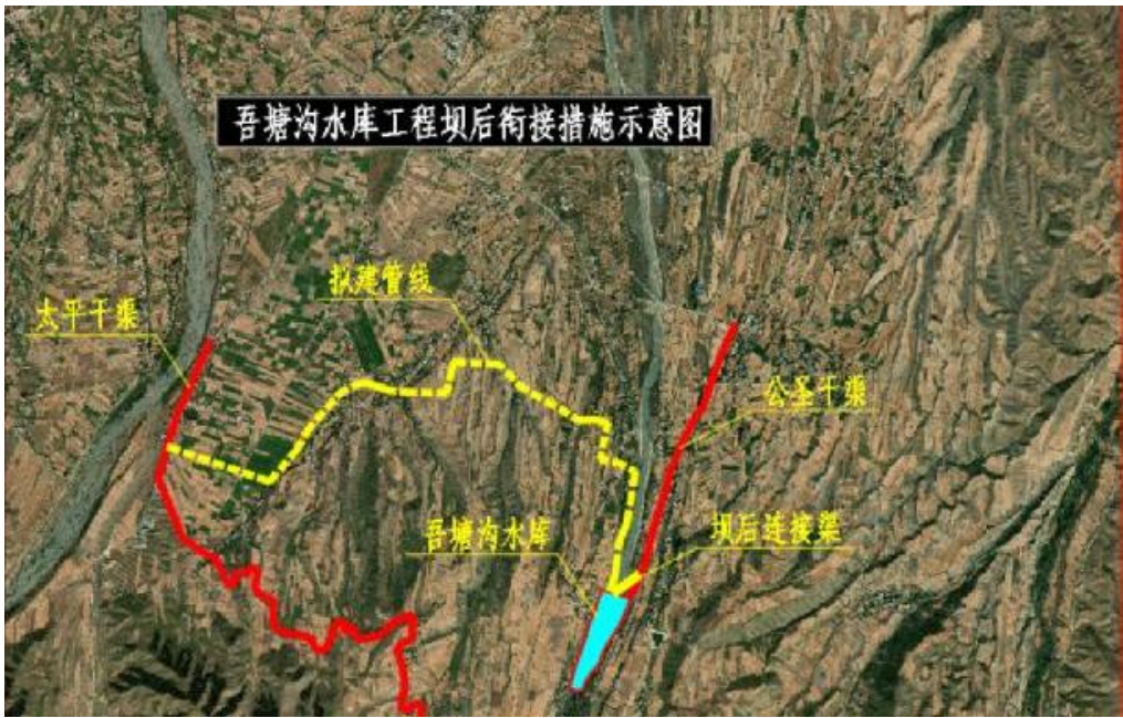
图2-1 吾塘沟水库坝后与灌区衔接措施示意图
