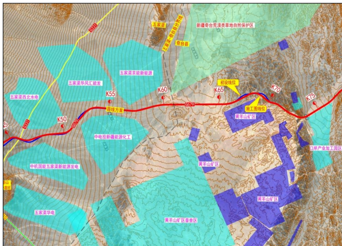
图 4.2-9 本项目伴行新疆奇台荒漠类草地自然保护区段路线方案图
