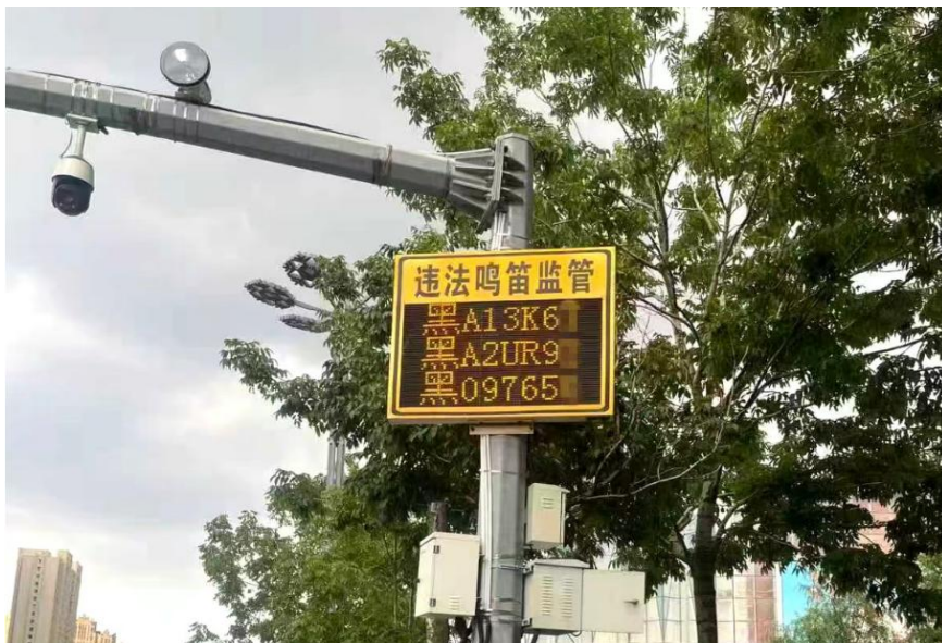
图 4-1 违法鸣笛抓拍系统
