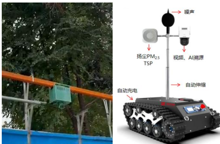
图 3-5 移动滑轨监测设备和智能巡检机器人
