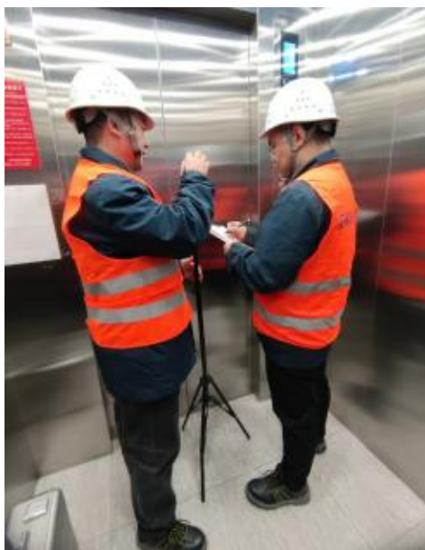
图 6-4 电梯噪声测试现场
