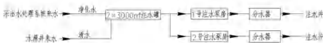
图 3.5-7 火烧山联合站注水系统流程框架图
