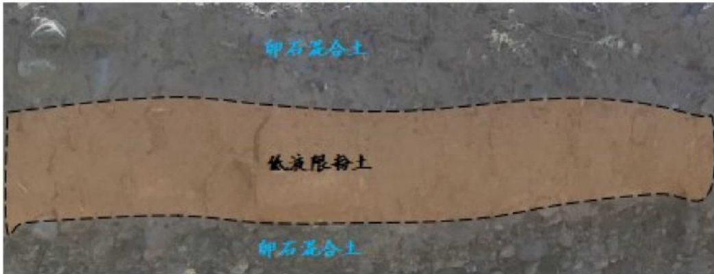
图5.1-2 灌区低液限粉土（局部）岩性照片
