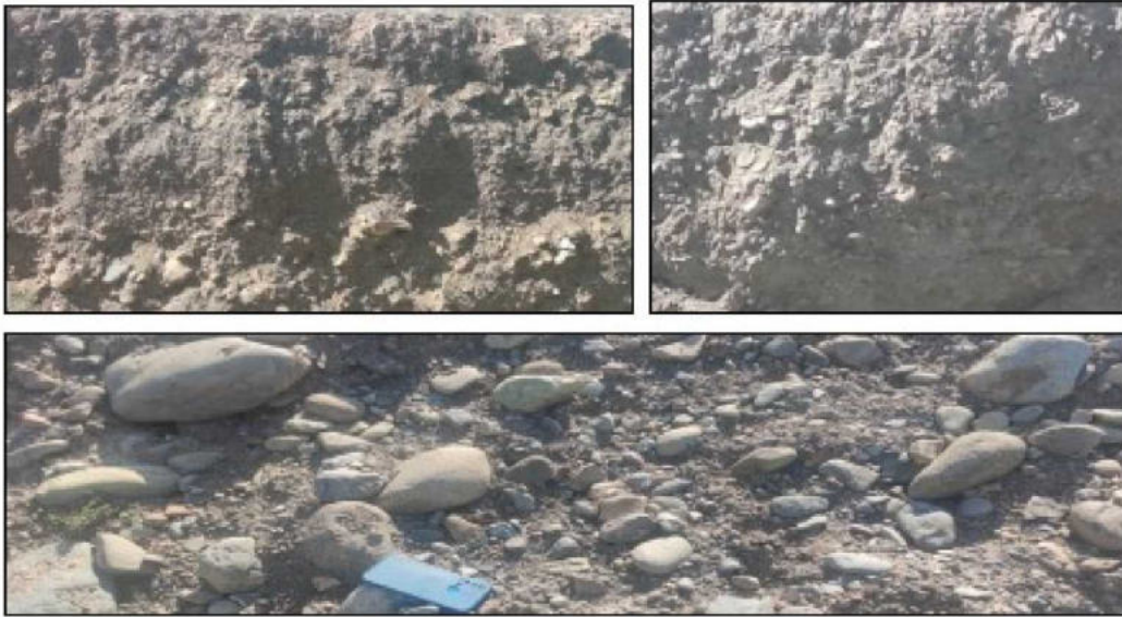
图5.1-1 灌区卵石混合土岩性照片
