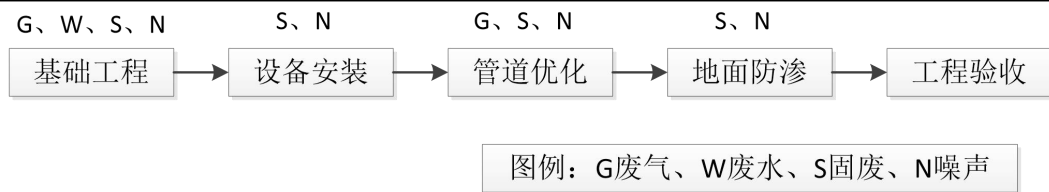
图 2-3 65t/h 燃气锅炉施工期工艺流程及产污环节图
