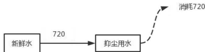
图 2-2 水平衡图 单位：t/a
