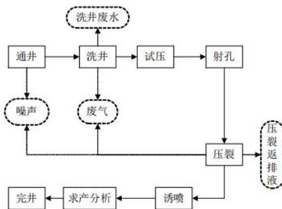
图 2-6 试油作业流程及产污节点图
