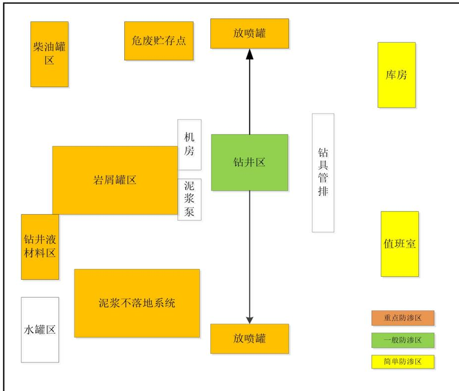
图 2-2 钻井井场平面布置示意图
