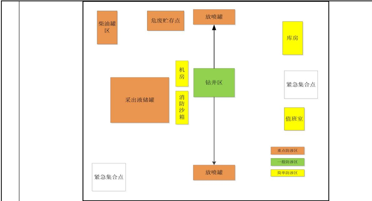
图2-3 油气测试井场平面布置图示意图
