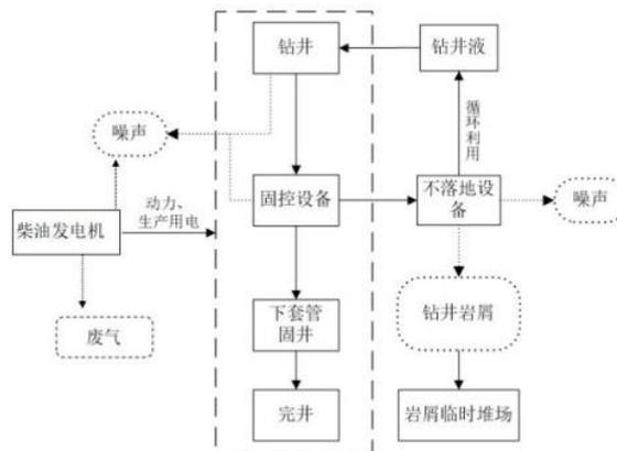
图 2-7 钻井施工作业流程及产污节点图
