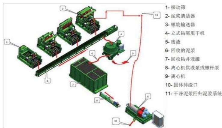
图 2-8 泥浆不落地处理系统工艺流程图
