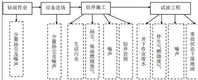
图 2-4 钻井工艺流程及产污节点图
