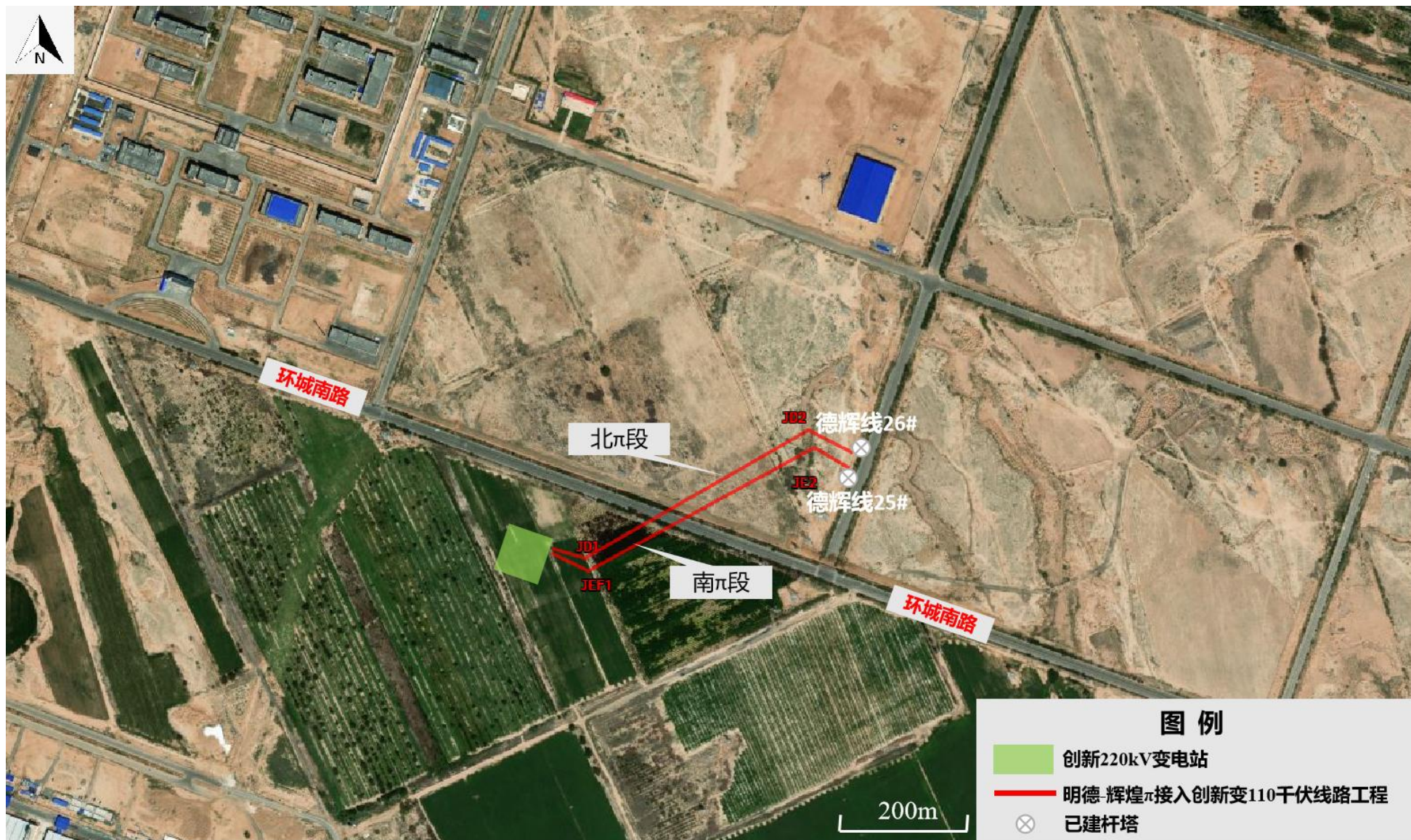
明德-辉煌 \pi 接入创新变 110 千伏线路路径走向示意图
