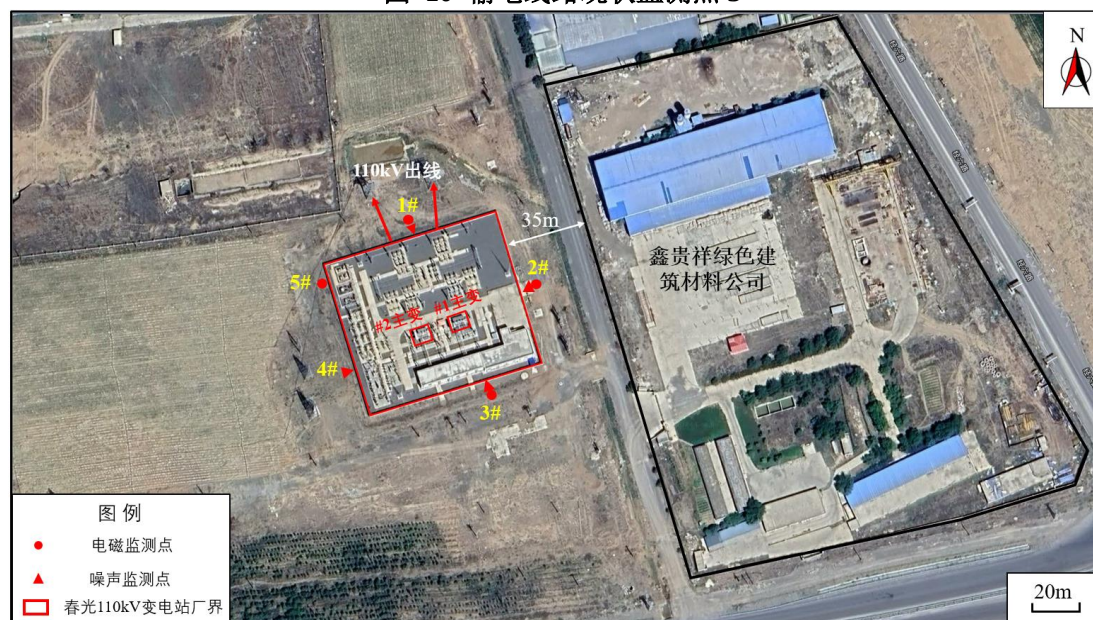
图 11 春光 110kV 变电站监测点示意图
