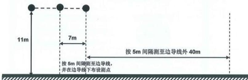
图 3 220kV 阜东寒一线噪声断面监测示意图
