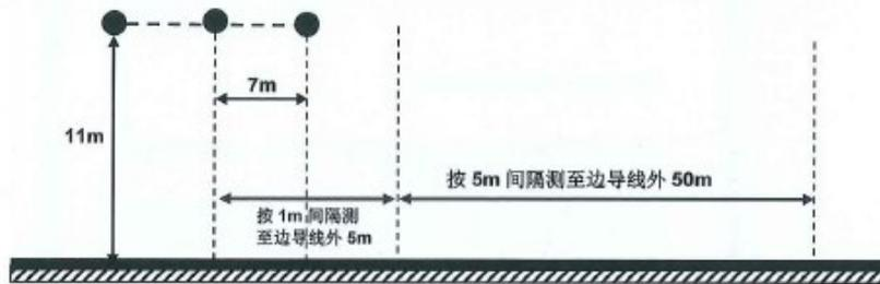
图 2 220kV 阜东寨一线电磁断面监测示意图
