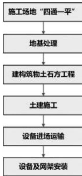
图 4 开关站新建工程主要施工工艺和方法图
