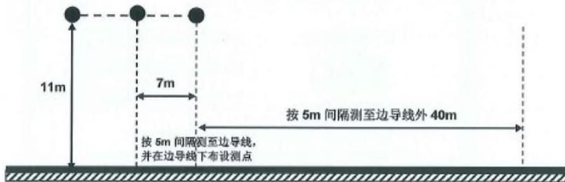
图 3 220kV 阜东寨一线噪声断面监测示意图
