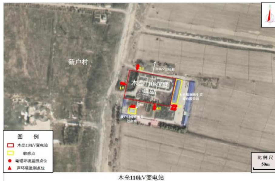
图 2 木垒 110kV 变电站监测点位示意图
