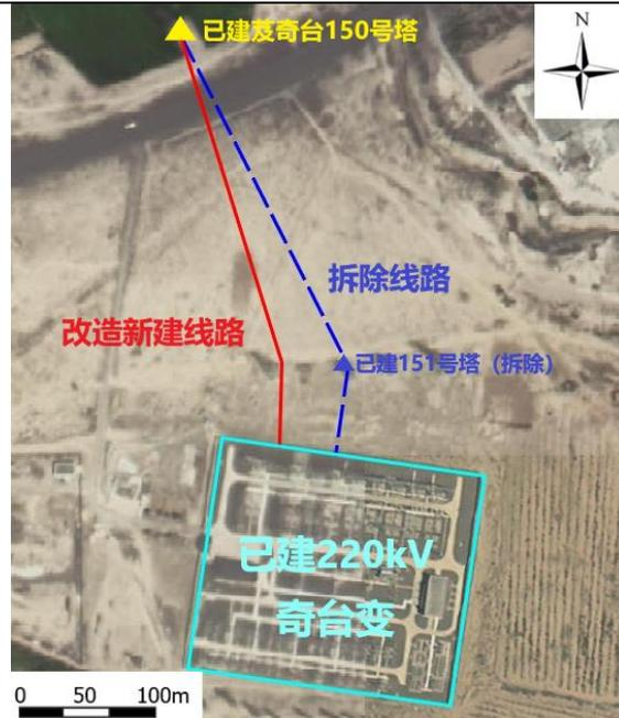
图 10 220kV 炭奇台 I 线改造工程路径
