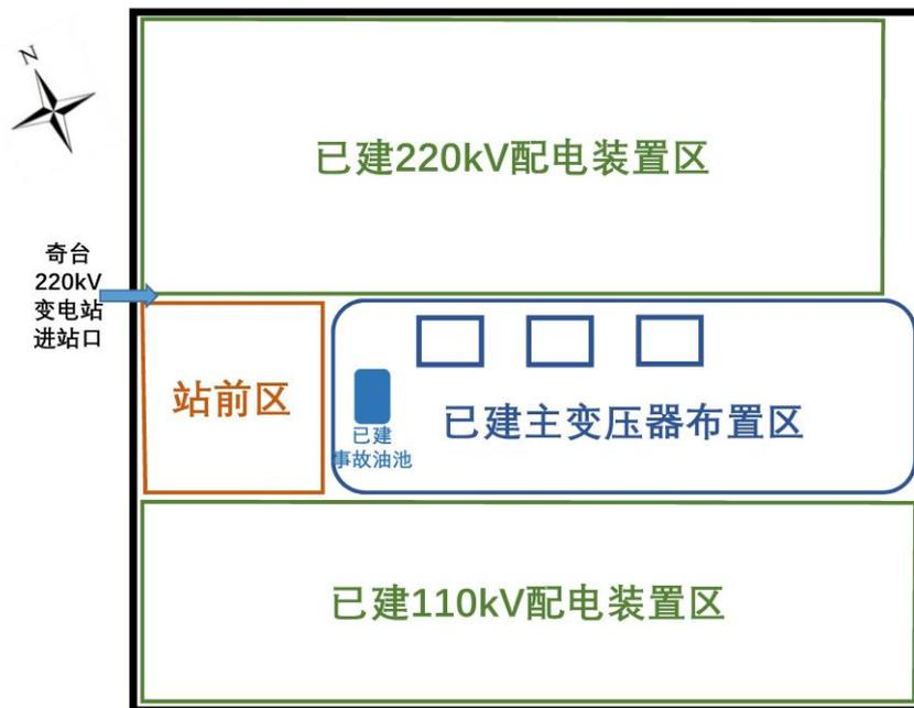
图 2 奇台 220kV 变电站现状布置图
