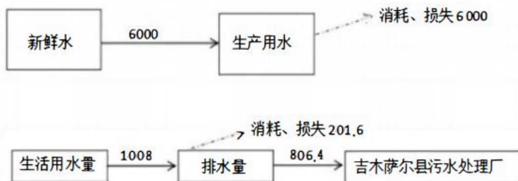
图2 本项目水平衡图 (m³/a)
