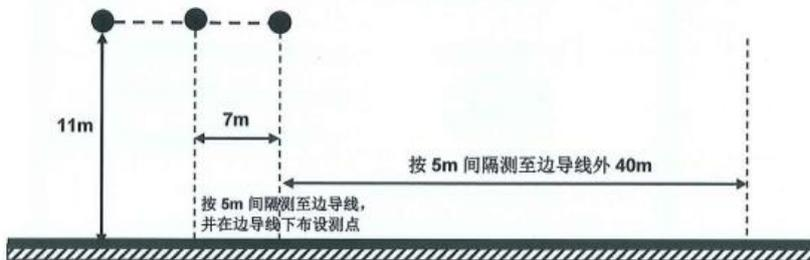
图 3 220kV 阜东寒一线噪声断面监测示意图
