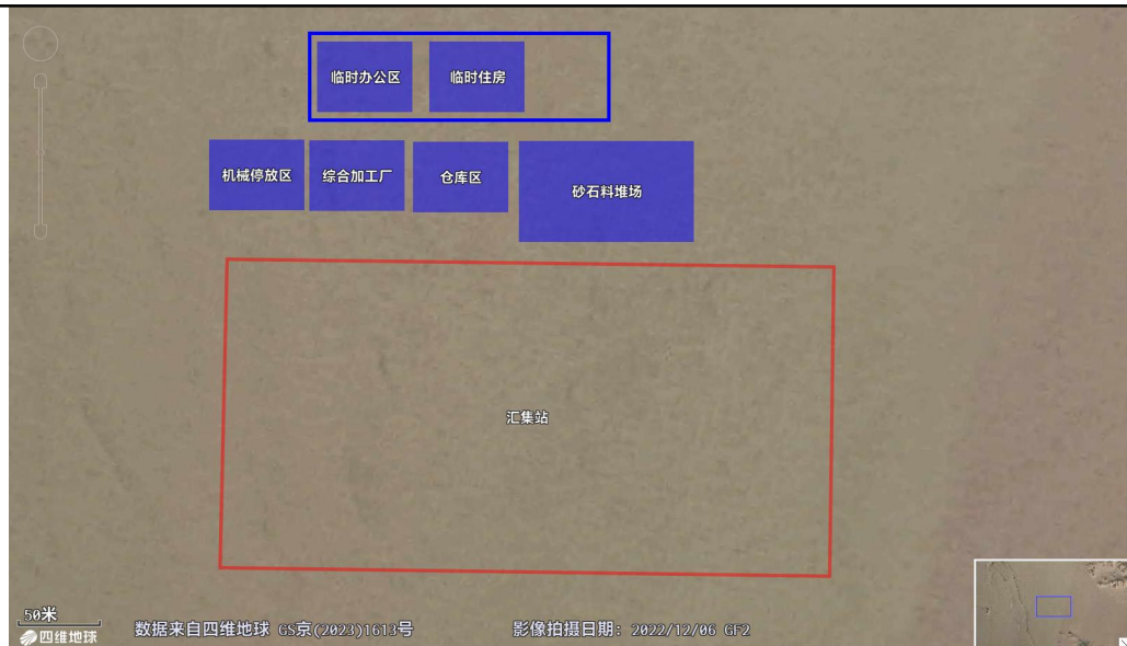
图 2-1 施工临建总平面布置图
