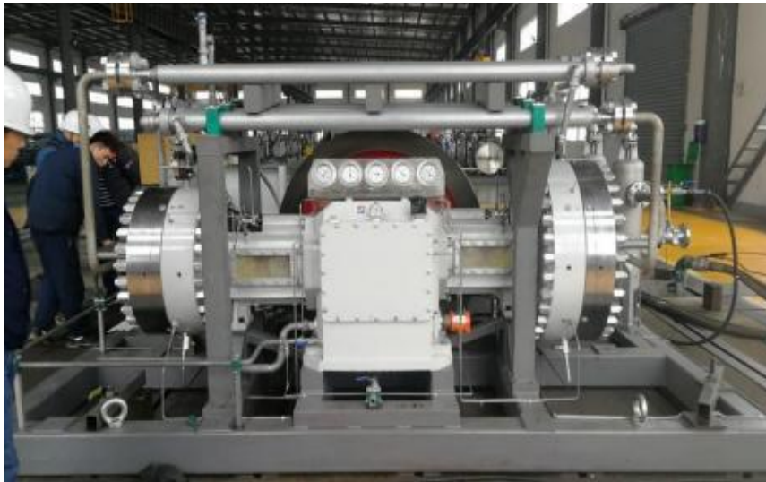
图 3.1-6 氢气压缩机设备图片
