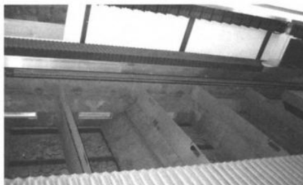
图 3 某欧洲品牌激光切割机, 3\text{m}\times 1.5\text{m} 工作台面, 切割区域分为五部分
