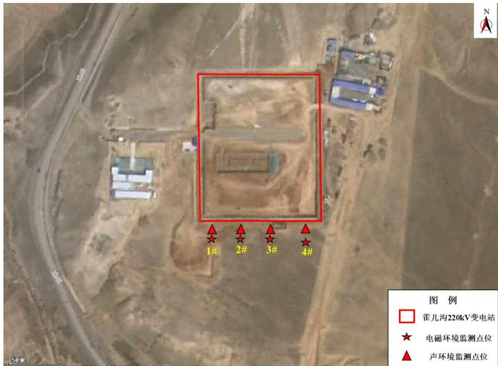
图 5 雀儿沟 220kV 变电站四至图及监测布点示意图
