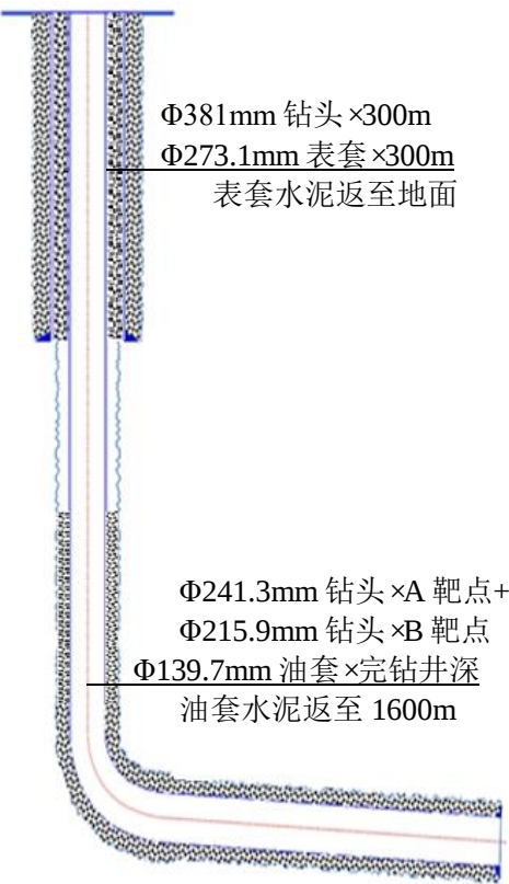
图 2-1 本项目井身结构示意图
