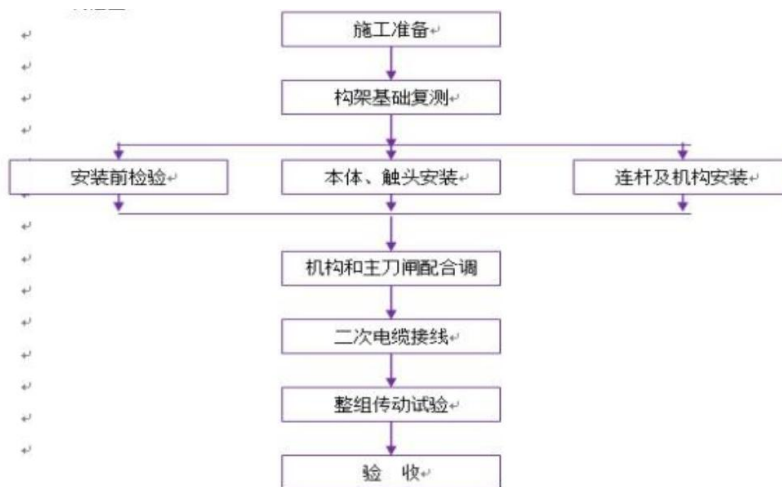
图2-3 隔离开关安装工序示意图
