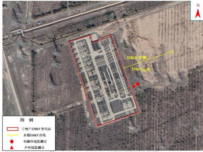
图 2 宁州户 220kV 变电站 110kV 间隔扩建侧检测点位示意图
