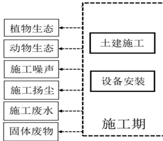
图4 变电站工程施工期的产污节点图
