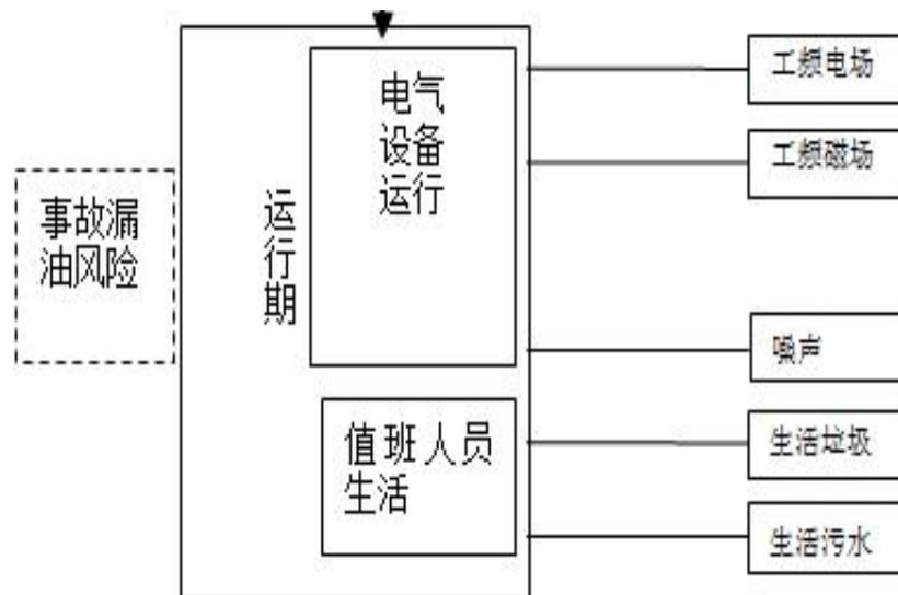
图 5 变电站工程运行期的产污节点图
