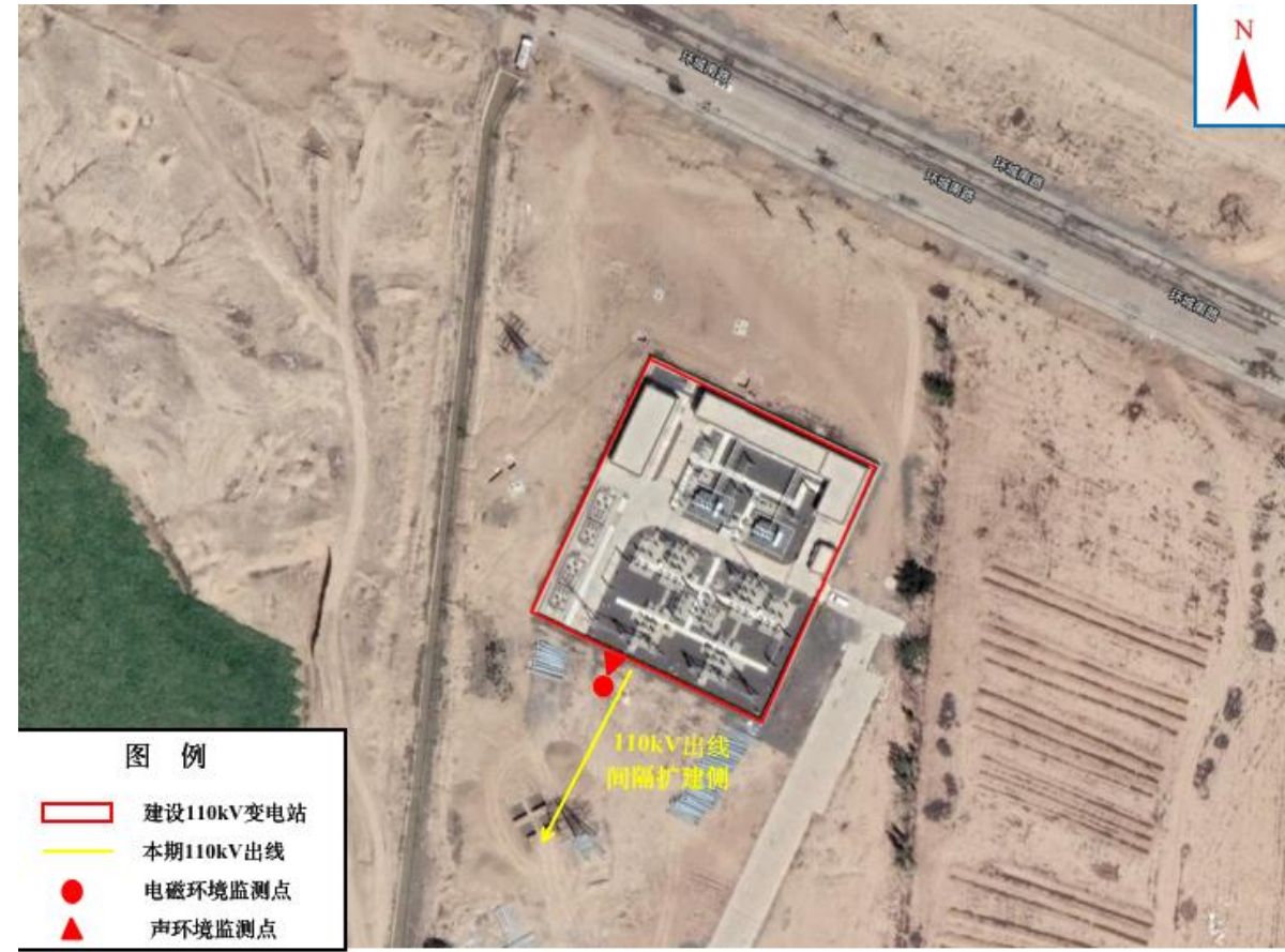
图 1 建设 110kV 变电站电磁环境现状监测点位示意图
