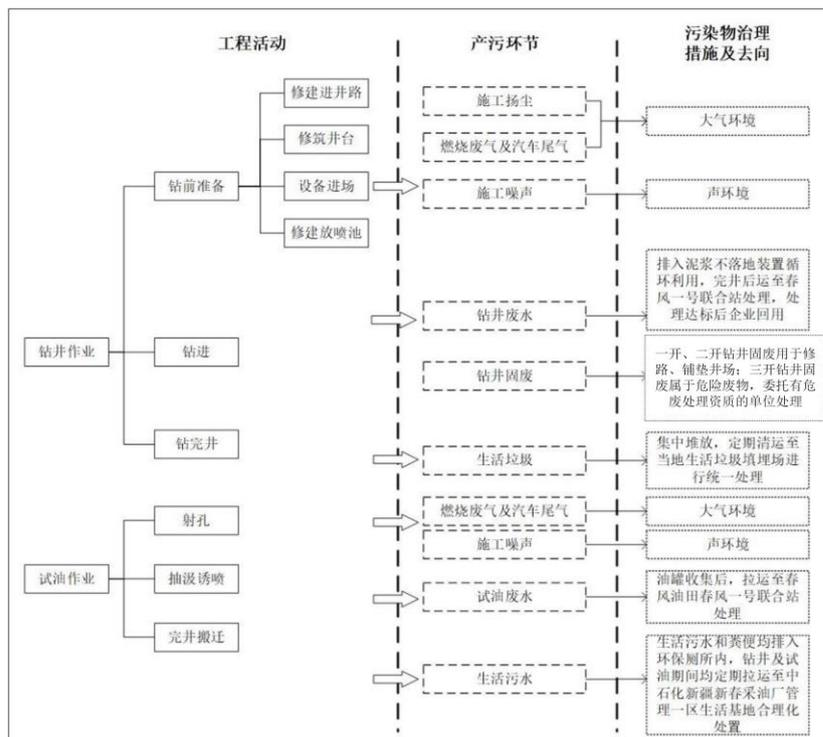
图 2 作业流程及产污节点图
