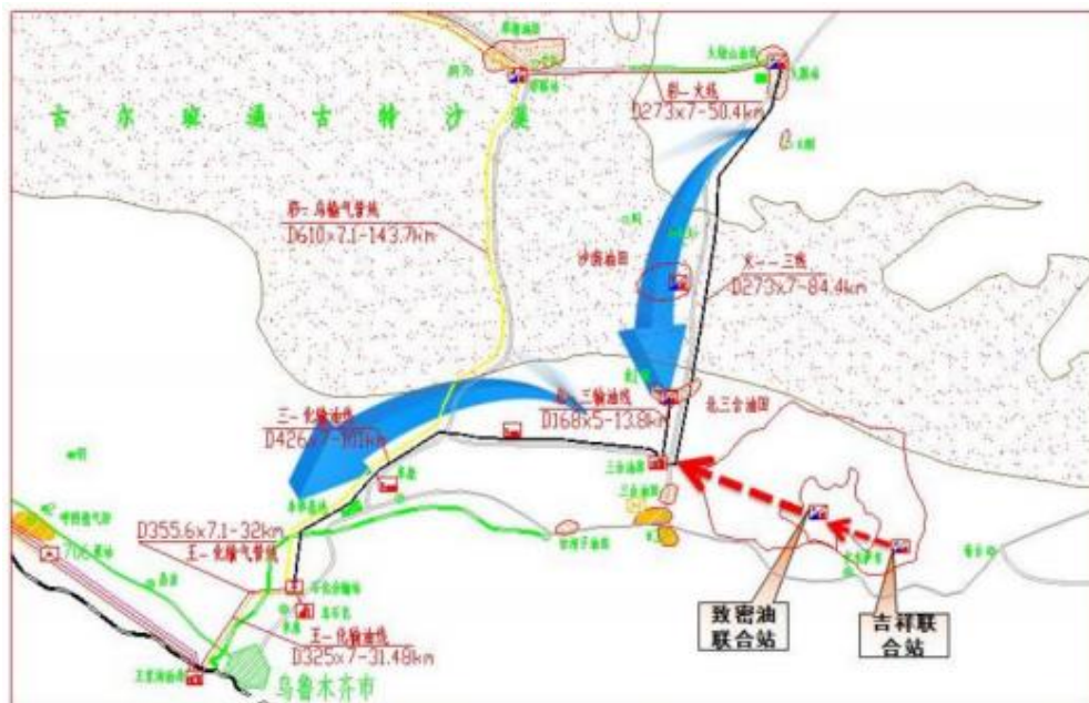
图 2-7 原油外输流向示意图
