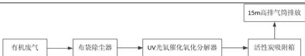
图 13 有机废气处理工艺流程图
