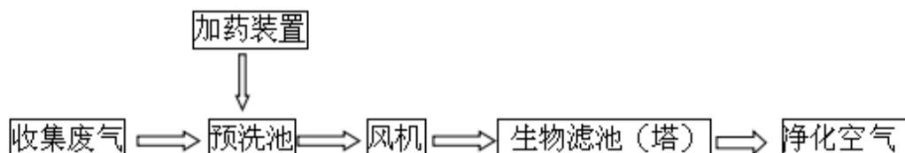
图 7.2-1 生物氧化除臭法工艺流程图
