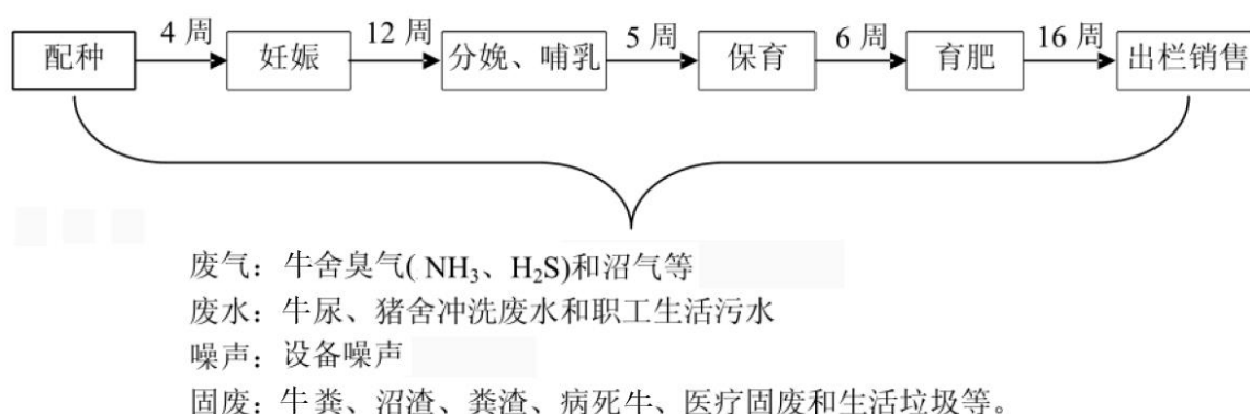
图 3.2-1 养殖工艺流程及产污节点图
