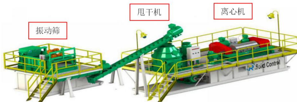
图 4.1 泥浆不落地装置平面布局示意图
