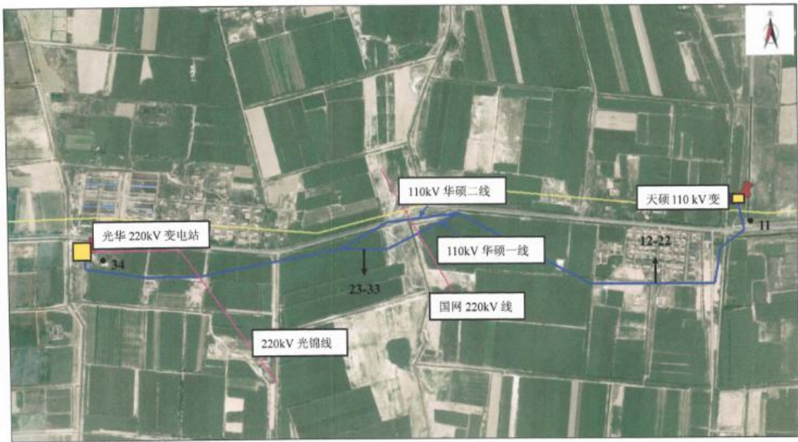
图 5 天硕 110kV 输变电工程华硕线 110kV 送电线路验收监测布点图
