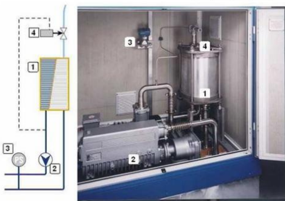
图 7 油气回收工艺流程
