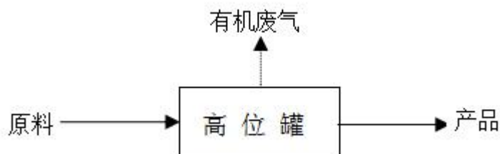
图 3-4 稀释剂生产工艺及产污流程图
