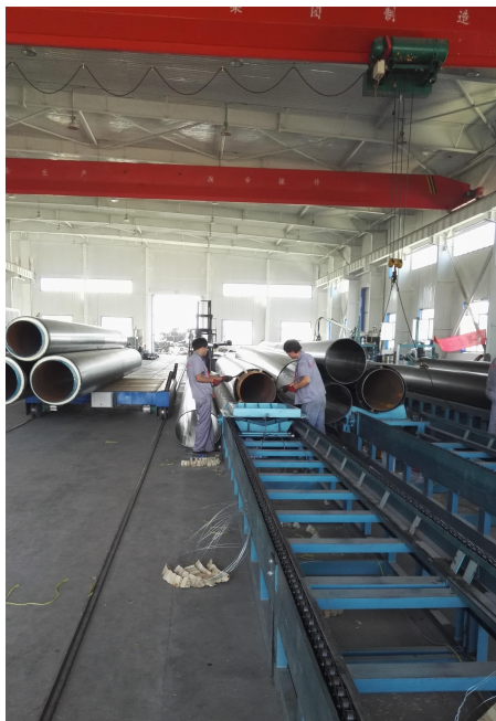
工艺环节-穿管
